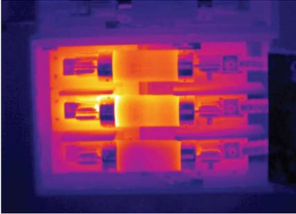
**Рис. 5-14.** Область светлого цвета на изображении блока предохранителей указывает на возможные проблемы связанные с высоким сопротивлением или на внутренние проблемы на центральной фазе.
