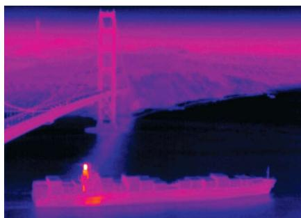
**Рис. 5-31.** Тепловое изображение контейнерного судна ночью показывает, что выхлопную трубу и машинное отделение можно обнаружить с очень больших расстояний.
