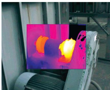
*Горячая крышка подшипника является признаком возможных проблем с соосностью, смазкой, или проблем с двигателем или с оборудованием, с которым он соединен.*
