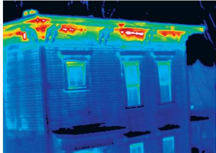
**Рис. 5-68.** Чрезмерные потери тепла могут быть вызваны теплым воздухом, проходящим через теплоизоляцию, что может привести к значительным и дорогостоящим проблемам во многих зданиях, даже если они имеют
