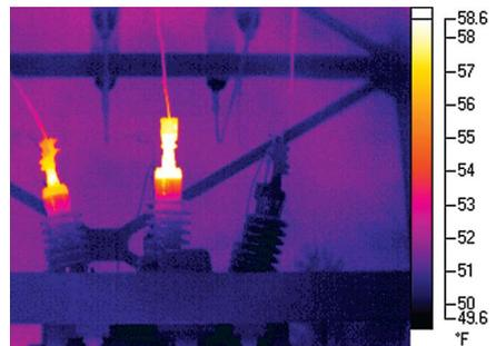
**Рис. 5-59.** Два из шести вводов маслonaполненного разъединителя имеют ненормальный нагрев и говорят о состоянии, которое может привести к серьезным финансовым последствиям, если бы его не выявили и не отремонтировали.
