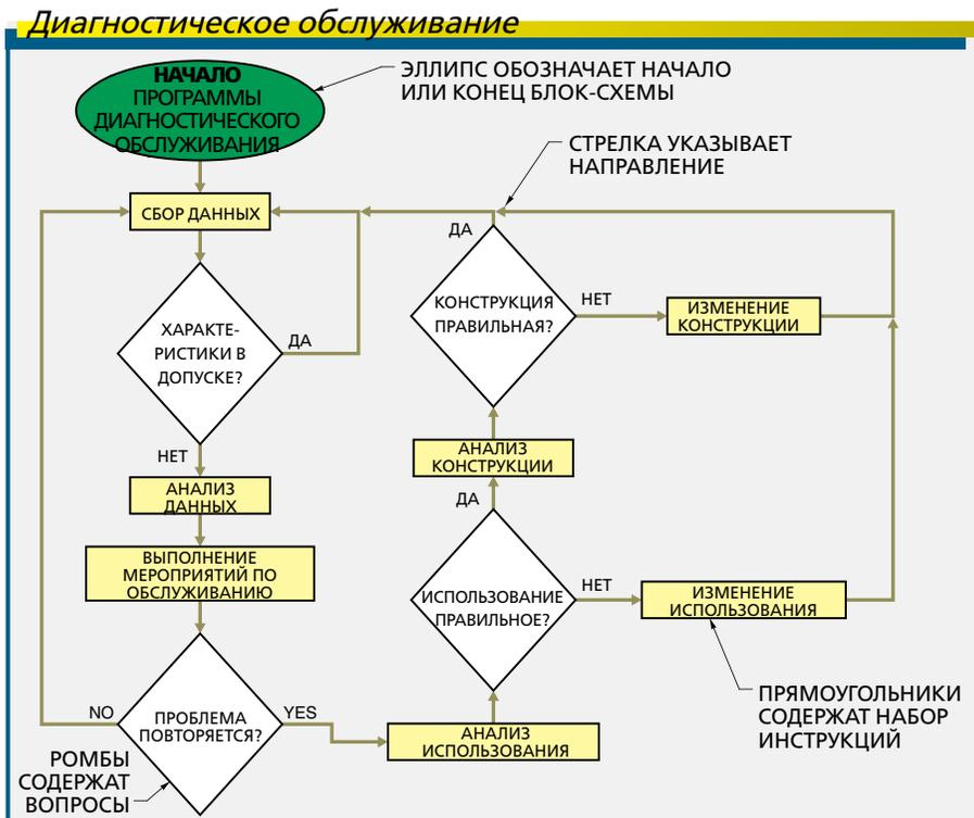
**Рис. 2-3.** Диагностическое обслуживание чаще всего применяется для дорогостоящего или критичного оборудования на предприятии.
