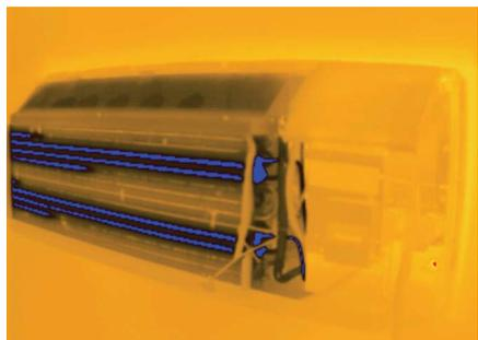
**Рис. 5-25.** Области темного цвета показывают, где проходит хладагент через теплообменники оконного кондиционера.
