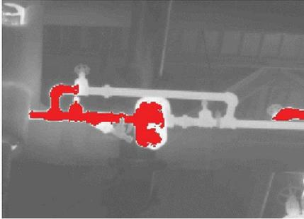
**Рис. 5-60.** Правильно работающий конденсационный горшок должен быть теплее со стороны пара и холоднее со стороны конденсата, как на данном изображении.
