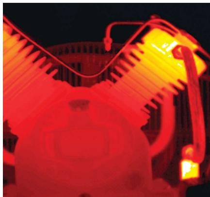
*Термограмма – это обработанное электронной изображением на дисплее, где различные градации цвета соответствуют распределению инфракрасного излучения по поверхности объекта.*
