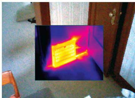
**Рис. 5-4.** Более светлые расплывчатые следы на тепловом изображении «картинки в картинке» выпускной заслонки указывают на воздушные течи в месте выхода воздушного канала.
