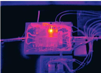
**Рис. 5-86.** Тепловое изображение может быть полезным для поиска контактных соединений с высоким сопротивлением в системах управления низкого напряжения.
