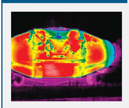
**Рис. 7-3.** Построение тепловых трендов используется для обследования высокотемпературного оборудования, у которого тепловые сигнатуры, например, как у данной торпеды (заполненной расплавленным металлом), могут быть сложными и могут указать на износ футеровки только с течением времени.
