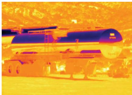
**Рис. 5-26.** Влияние материалов с низким коэффициентом излучения в тепловидении проявляется на изображении грузовика с емкостью из листового металла. Металл отражает холодное ясное небо и тепло, исходящее от земли в солнечный день.
