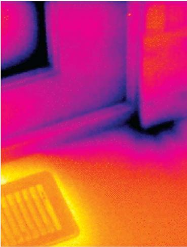
**Рис. 6-6.** Тепловые следы, связанные с течами воздуха, часто имеют характерный «размытый» вид.
