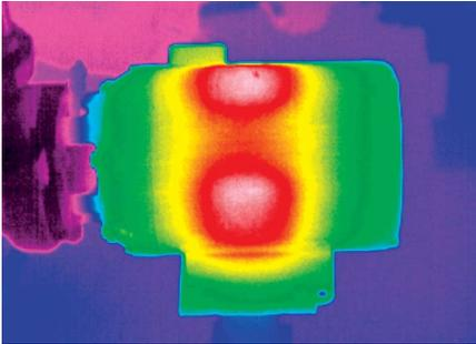
**Рис. 5-78.** Тепловой рисунок на нормально работающем двигателе насоса должен иметь равномерное распределение температуры.
