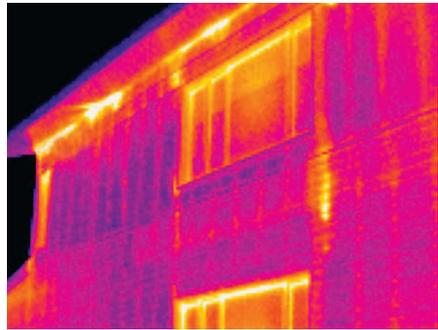
*Тепловидение можно использовать для поиска потерь тепла в зданиях вокруг таких участков, как окна, карнизы или в стенах с плохой теплоизоляцией.*
