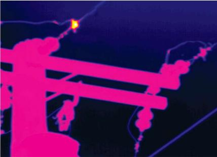
**Рис. 5-16.** Соединение с высоким сопротивлением на перемычке (возможно вследствие коррозии) может иметь значительные последствия при дальнейшем увеличении нагрузки.
