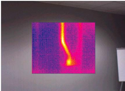
**Рис. 5-33.** Даже незначительные выявленные на поверхности температуры могут говорить о серьезных проблемах, таких как общая нейтраль или неправильное заземление в системе освещения. Это может вызвать нагрев металлического кабелепровода в стене до состояния, когда может возникнуть опасность возгорания.
