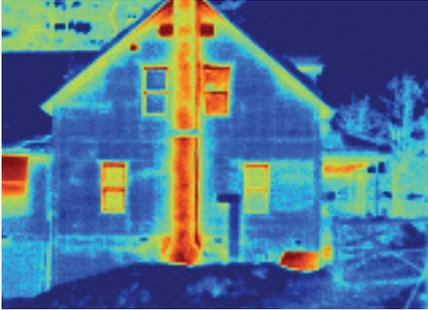
**Рис. 5-48.** Тепловое изображение наружного вида здания может четко указать на проблемные зоны, такие как светлые участки, где отсутствует теплоизоляция.
