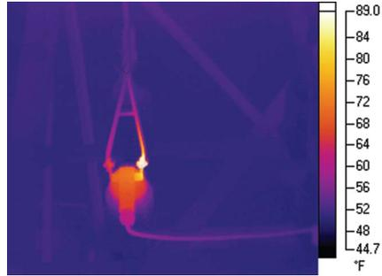
**Рис. 5-37.** Поскольку параллельные пути для прохождения тока существуют во многих разъединителях, перегрев может показывать нормальное соединение, а местом, где на самом деле существует проблема, может быть холодная часть.
