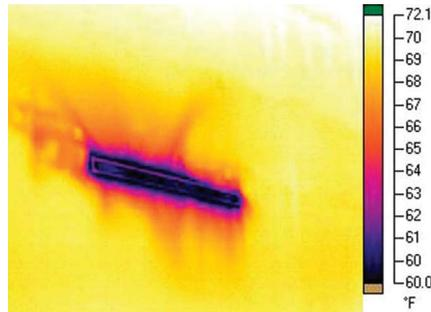
**Рис. 5-41.** Кондиционированный воздух может проникать через места соединения воздушного канала системы ОВКВ в стену за диффузором.
