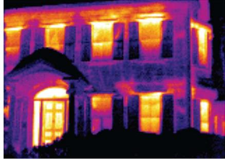
**Рис. 5-49.** Области с отсутствующей теплоизоляцией проявляются в виде теплых участков на внешних стенах здания в холодную погоду.
