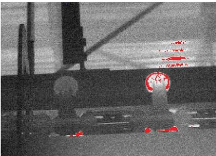
**Рис. 5-52.** Ненормальный нагрев подшипника конвейерной ленты может привести к чрезмерному расходу энергии и со временем к растяжению цепи.
