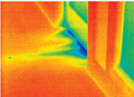
**Рис. 5-80.** Холодный воздух просачивается под входной дверью и оставляет размытый неоднородный след на полу в прихожей.
