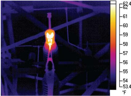
**Рис. 5-36.** Ненормально высокое сопротивление вызывающее нагрев разъединителя часто представляет серьезную дорогостоящую проблему, поскольку даже сравнительно невысокие температуры могут вызвать повреждение.
