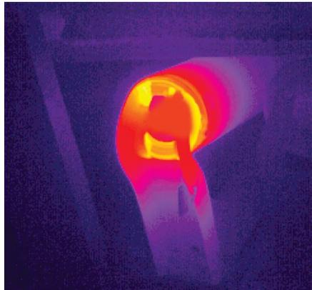
*Качественная термография обычно не требует знания радиометрических значений температуры. Она позволяет сравнить контрасты тепловых изображений похожих компонентов.*
