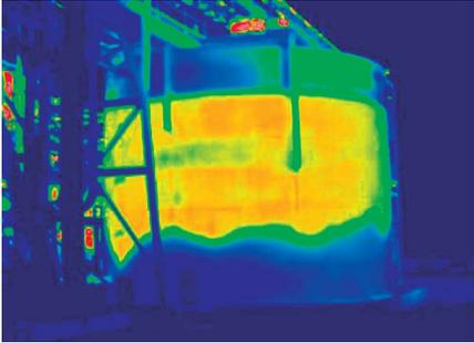
**Рис. 5-71.** Уровень жидкости и осадка в емкости можно часто обнаружить в момент, когда емкость находится в переходном тепловом состоянии.
