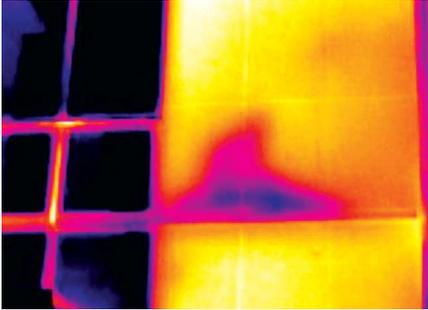
**Рис. 5-76.** Влага может проникать в каменную облицовку коммерческих зданий и приводить к повреждениям.
