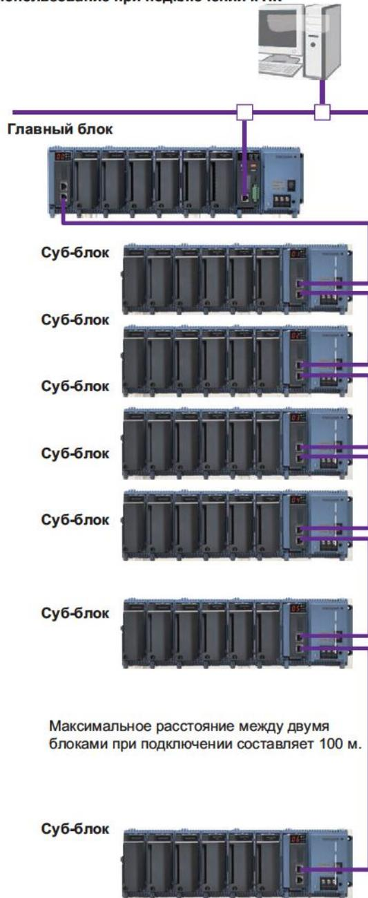
Максимальное расстояние между двумя блоками при подключении составляет 100 м.
