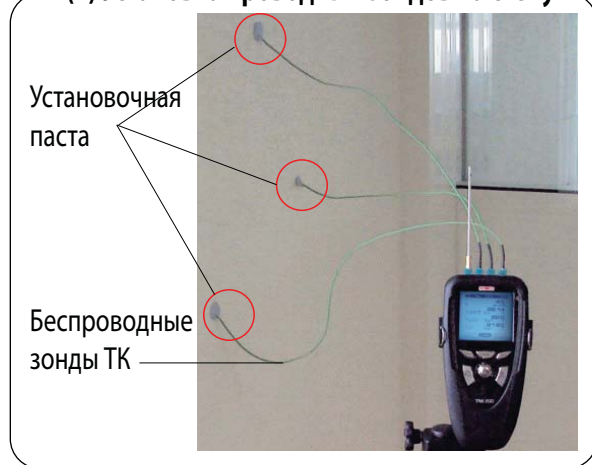
(1) Установка проводных зондов на стену
