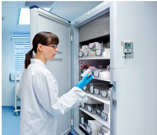
Зонды с плоским кабелем, доступные для заказа, были разработаны специально для безопасного мониторинга температуры в холодильниках.
