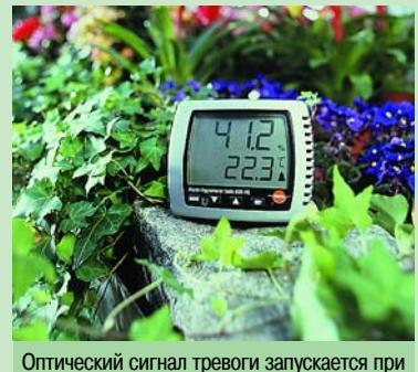
Оптический сигнал тревоги запускается при превышении сигнальных значений (608-H2)
