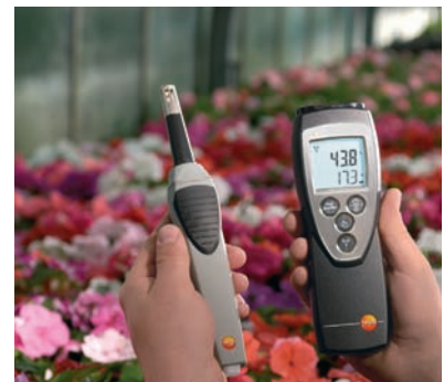
Наконечник зонда влажности подсоединяется к рукоятке радио зонда, для мониторинга на соответствие климатических нормам
