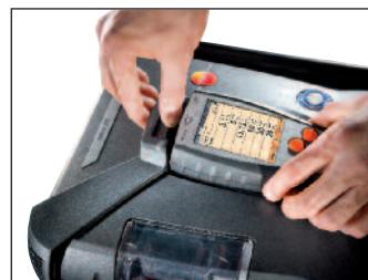
Управляющий модуль просто "зашелкивается" в блок анализатора
