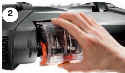
**В. Блок анализатора** в ударопрочном корпусе обеспечивает защиту сенсоров, насосов и внутренней электроники.
