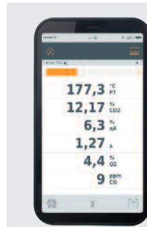
Управление измерительным прибором, а также отображение измеренных значений осуществляется по Bluetooth с Вашего смартфона или планшета с помощью мобильного приложения для testo 330i, независимо от места замера. Помимо этого, Вы можете создавать отчеты, добавлять к ним фотографии и комментарии и отправлять их по e-mail. Для мобильных устройств на базе iOS и Android.
