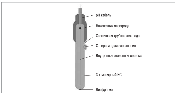
Рис. 8: Конструкция электрода сравнения
