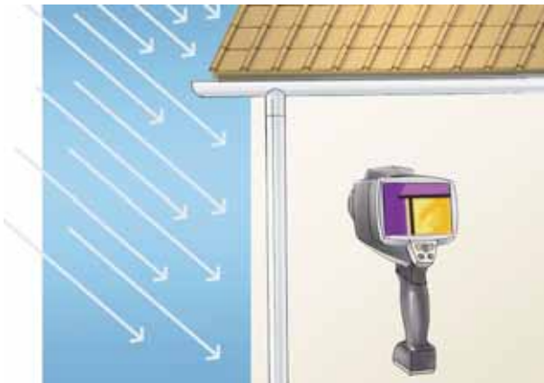
Рис. 2.1: Отражение при измерениях проводимых на открытом воздухе
