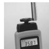
Механическое измерение с вращ. диском
