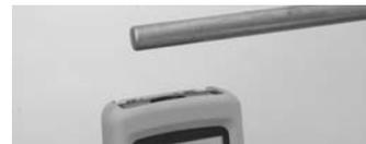
Бесконтактное (оптическое) измерение
