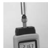
Механическое измерение с наконечн. зонда
