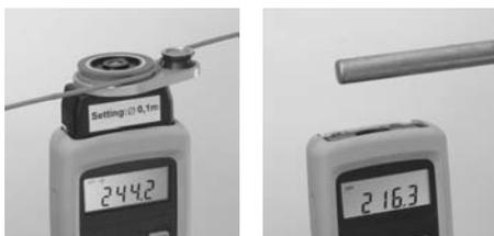
Механическое измерение со счетчиком для нити
