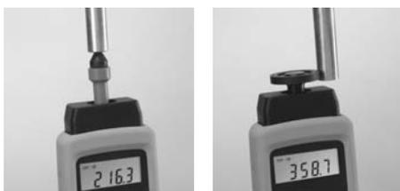
Механическое измерение с наконечником зонда
