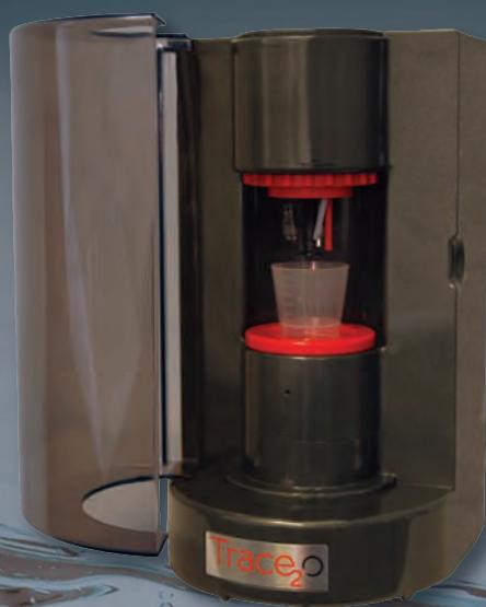
**Уникальное портативное решение для лабораторного анализа тяжелых металлов. В основу заложен вольтамперметрический принцип действия. Подходит как для применения в промышленности, так и для научных исследований и разработок.**
